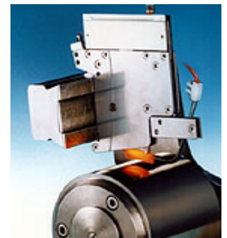
Type PQAS-H Coupe à Chaud 9,525 mm - 750°C - 70 m/min
