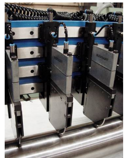
Type PQD-MC-2 19mm 1080N-6bar Positionnement automatique
