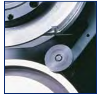
Einstellschieber einfache Einstellung zum Untermesser
