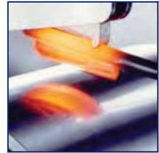
Heißschnitt in Funktion Schneidtemperatur 750°
